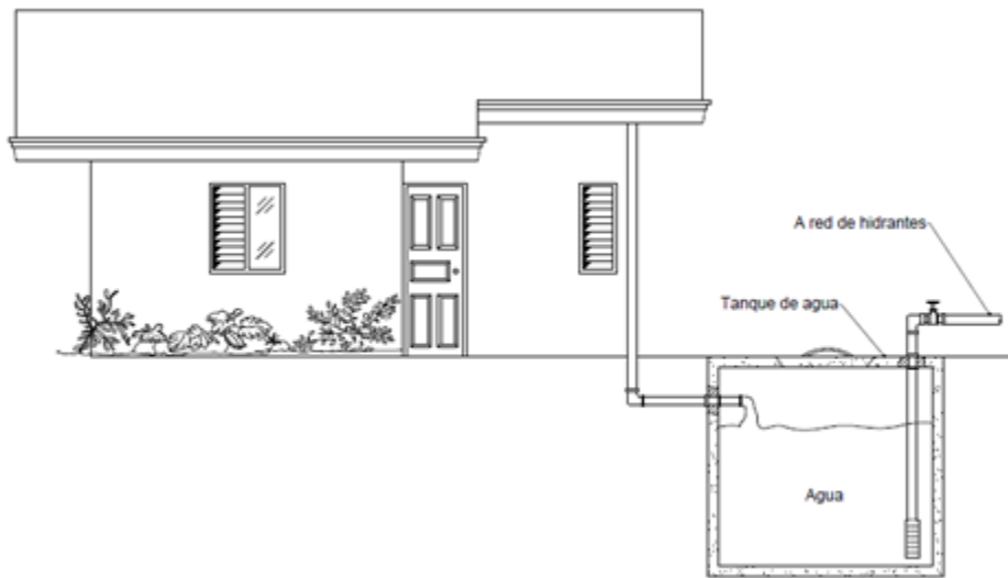
Figura 21. Captación única de agua pluvial para el abastecimiento de un tanque bajo nivel.
