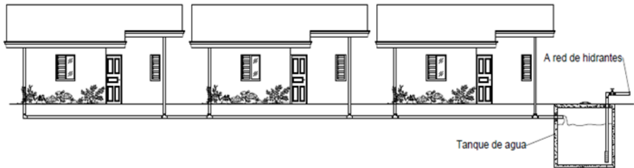
Figura 22. Captación múltiple de agua pluvial para el abastecimiento de tanques bajo nivel.
