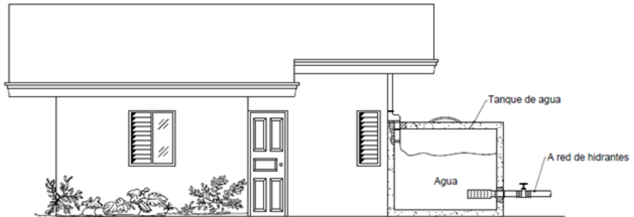
Figura 20. Captación única de agua pluvial para el abastecimiento de un tanque sobre nivel.
