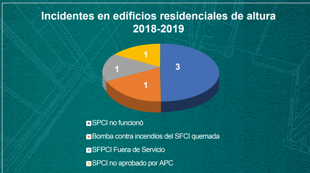
Gráfico 3 Incidentes de incendio registrada en edificios verticales de apartamentos Fuente: Benemérito Cuerpo de Bomberos de Costa Rica
